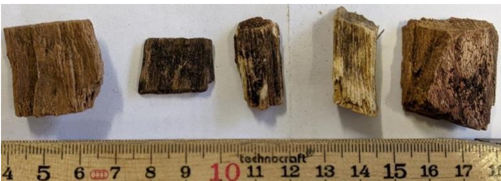
Illustration 2: Plaquettes de bois présentant des signes nets de perte de substance due à une attaque fongique (état de décomposition).
