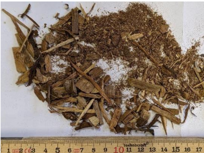
Illustration 1: Echantillon de bois avec un taux de fines élevé et un grand nombre de plaquettes longues et fines
