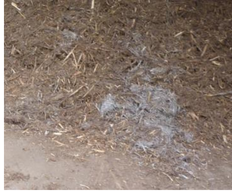
Illustration 3: A gauche: plaquettes de bois avec un taux de verdure élevé (aiguilles) à côté de plaquettes obtenues à partir de grumes-énergie. A droite: bois broyé présentant un taux de fines élevé et une attaque fongique visible.
