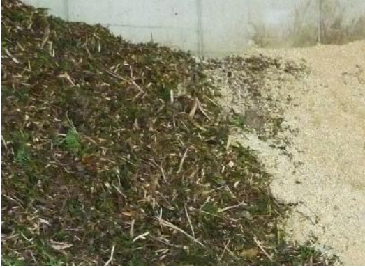
Illustration 3: A gauche: plaquettes de bois avec un taux de verdure élevé (aiguilles) à côté de plaquettes obtenues à partir de grumes-énergie. A droite: bois broyé présentant un taux de fines élevé et une attaque fongique visible.
