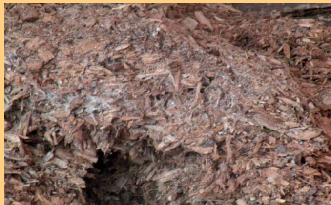
L'effetto spugna porta a una cattiva essiccazione con formazione di muffe (ardens GmbH, 2017)
