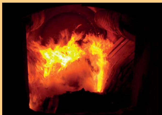
Carenza di aria con sviluppo di fumi (ardens GmbH, 2017)
