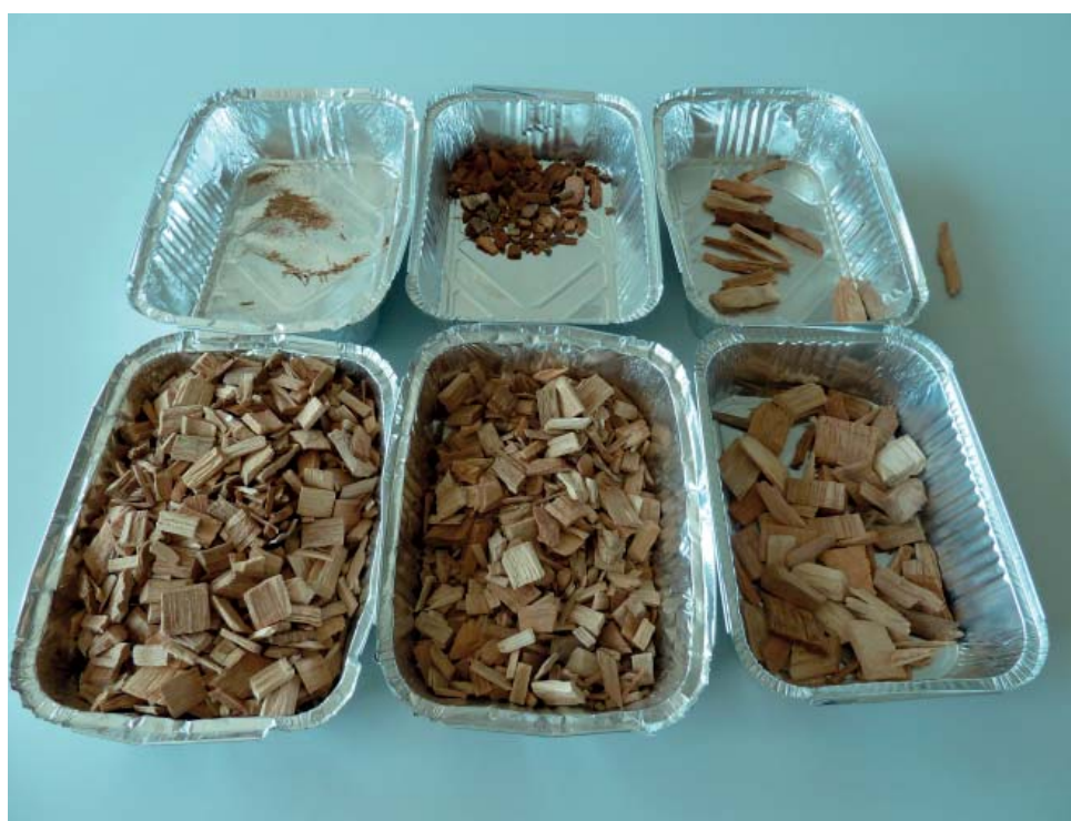
Diverse frazioni di un campione di cippato
