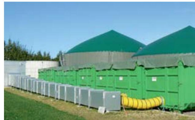
Séchage en conteneur mobile avec chaleur résiduelle d'une installation de biogaz. (Moser, 2015).
