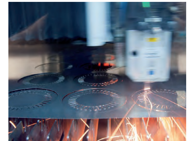
Wenn moderne Produktion neue Wärmelösungen ermöglicht: Laser-Schneidmaschine mit Mehrfachnutzen.
