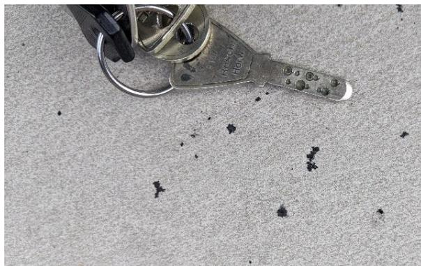
Illustration 1 En cas de contamination de l'environnement direct par des dépôts de poussières grossières, on pourra, par exemple, déployer au sol une bâche en non-tissé afin de mieux documenter les faits. Sur les photos, on montrera par exemple une clé ou un stylo à bille en guise de grandeur de comparaison.
