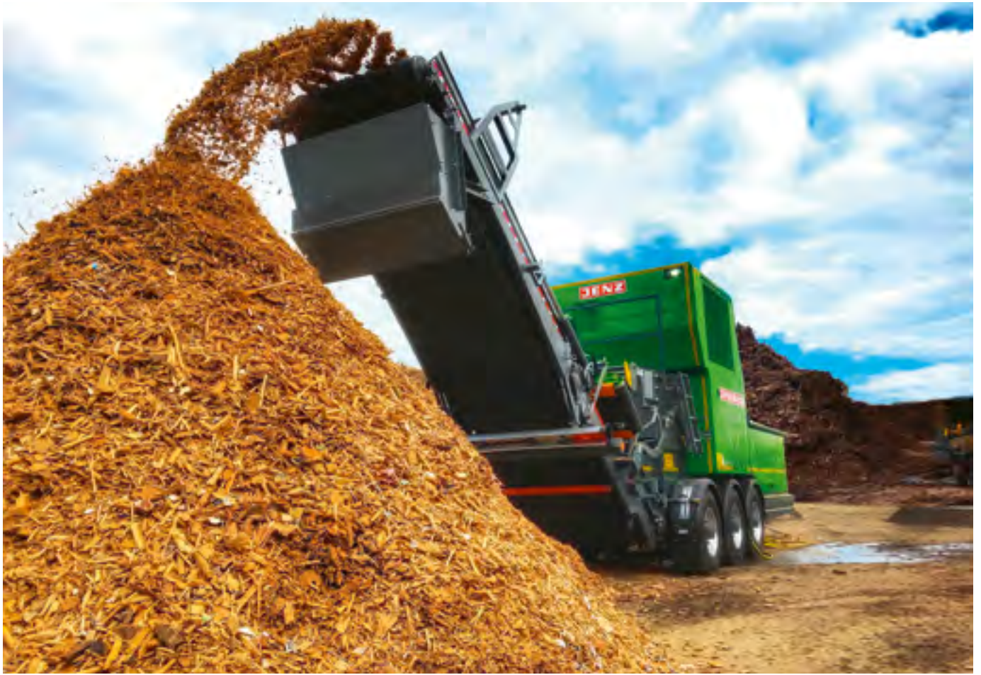
Les broyeur produisent des plaquettes de bois irrégulières, fibreuses et brisées. Photo: Jenz
