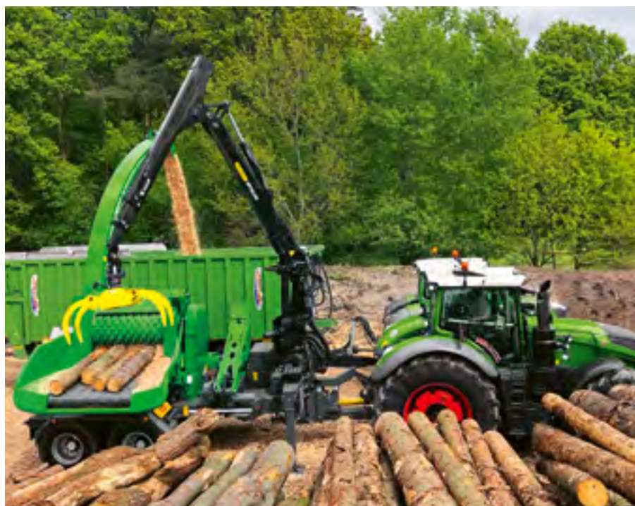
À partir de grumes, la déchiqueteuse produit des plaquettes dépourvues de fraction fine.
