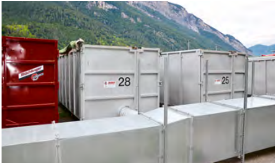
Le principe du conteneur de séchage réside dans le fait que le matériau à traiter est traversé par de l'air chaud remontant par le bas. Photo: Ruedi Hunger
